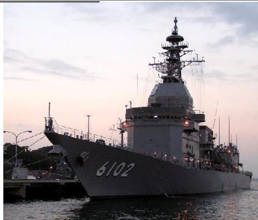
見ない、計画当初から、開発中の装備品を搭載し、護衛艦と同等の環境下で海上試験を行うためのプラットフォームとして建造された、最新の「たかなみ」型護衛艦とほぼ同程度の大きさを有するユニークな艦である。
